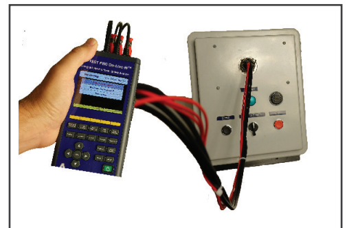
ALL-SAFE instalado dentro de la caja de inicio, conectado a ATPOL III™ para comenzar a tomar lecturas.
